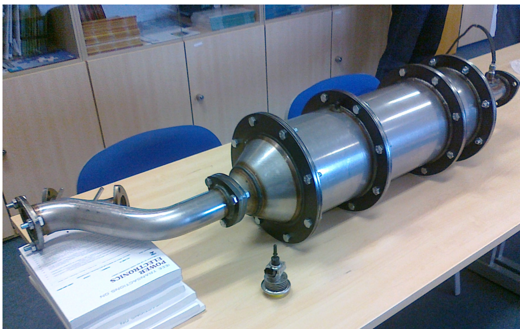
Obrázek 12: První prototyp SCR + DOC katalytického konvertoru s částí výfukového potrubí
