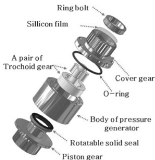
Obrázek 10: Hydraulický samosvorný diferenciál, převzato z [20]
