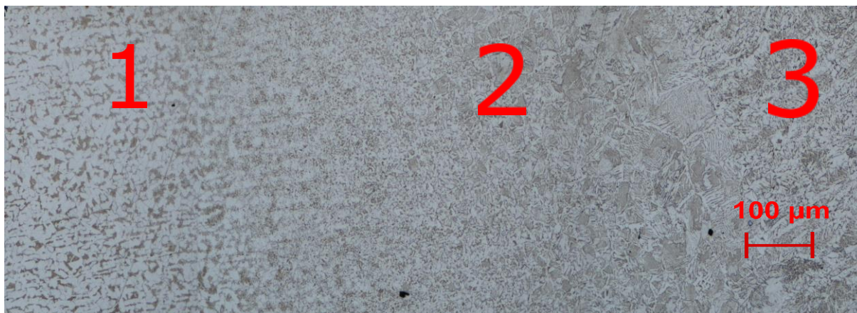
Obr. 15: Svarový spoj: 1- základní materiál, 2 - TOO, 3 - svar
