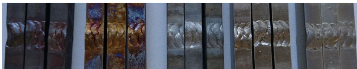
Obr. 24: povrchové úpravy (z leva: CrO 3 , tepelná úprava, galvanické pozinkování, chemické poniklování, galvanické poniklování)
