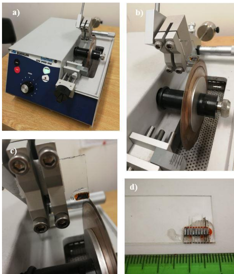
Obrázek 10: Řezání plátek: a) Pomaloběžná kotoučková pila IsoMet Buehler, b) Je vhodné umístit vzorek při řezu kolmo k řeznému kotouči, c) Detail kolmého řezu, d) Nařezané plátky na podložním (řezném) skle.
