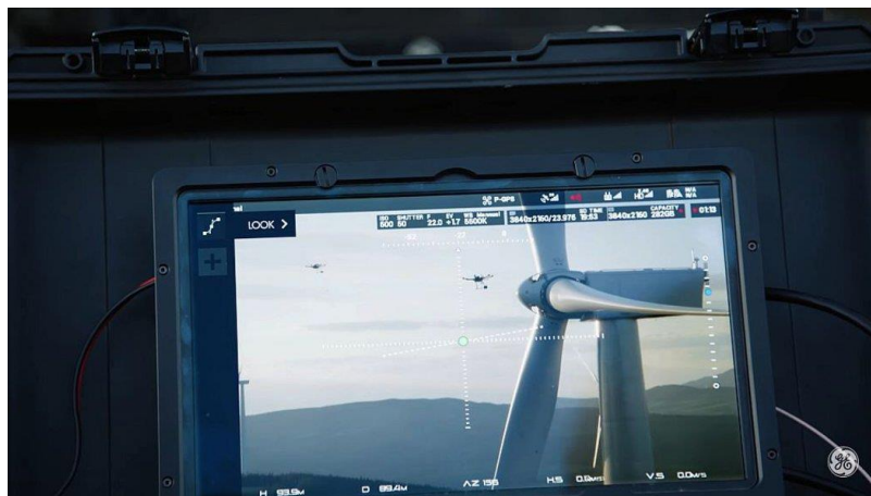
Obr. 39 – Obraz snímající dronem při kontrole větrné turbíny [37]
