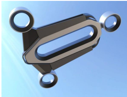
Obr. 42 – Použití Dysonových turbín pro pohon dronu [39]
