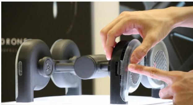
Obr. 41 – Pohon dronu na principu odstředivého čerpadla [39]
