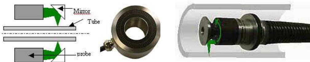
Obr. 69 – Kontrola vnější části trubek pomocí plochého kruhového pole a zrcadla [58]
