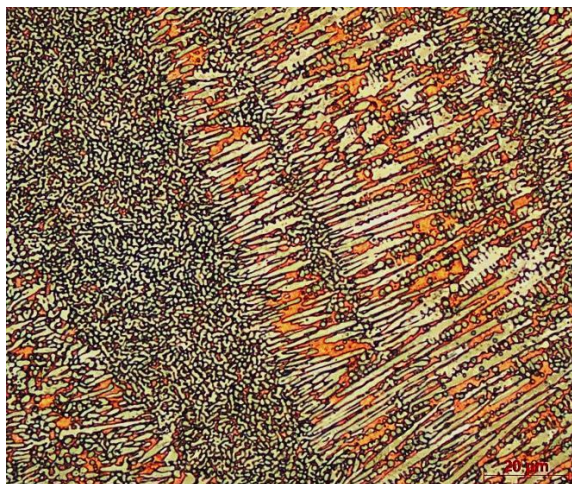
Obrázek 7-9 Vzorek Cu90_čedič10_z5, leptáno Robin, zvětšeno 1000x
