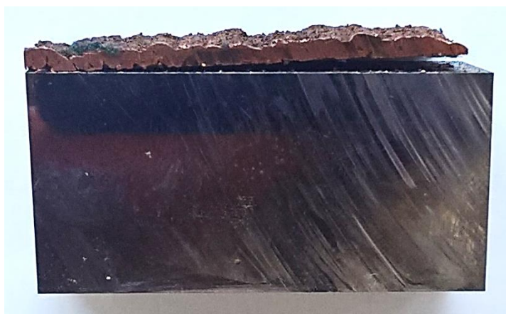
Obrázek 7-4 Kompozitní laserový návar měď-čedič s 5 hm. % čediče
