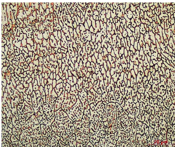
Obrázek 7-14 Vzorek Cu85_čedič15_z1, leptáno Robin, zvětšeno 1000x
