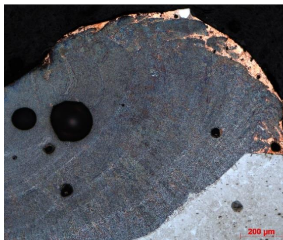
Obrázek 7-11 Vzorek Cu90_čedič10_z4, leptáno Robin, zvětšeno 100x
