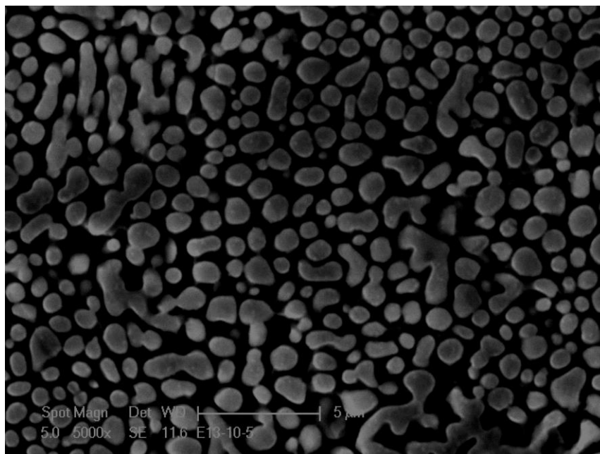
Obrázek 7-13 Cu_90_čedič10_z3, EDX analýza chemického složení, SEM, zvětšení 5000X
