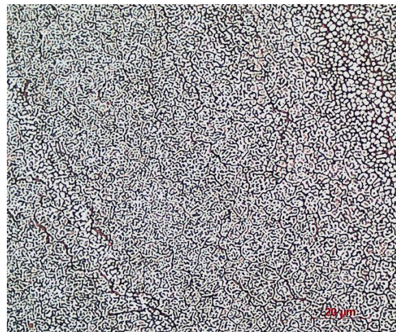
Obrázek 7-17 Vzorek Cu85_čedič15_z4, leptáno Robin, zvětšeno 1000x
