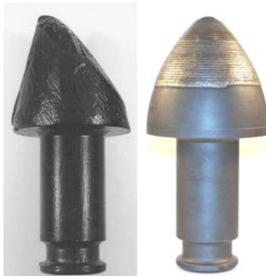
Obrázek 2-4 Vysoce opotřeбенý trn na výrobu trubek po 8 hodinách práce. Repasovaný trn s návarem na bázi karbidu wolframu a kobaltu. [14]
