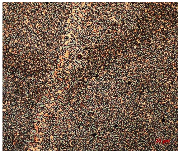
Obrázek 7-15 Vzorek Cu85_čedič15_z2, leptáno Robin, zvětšeno 1000x
