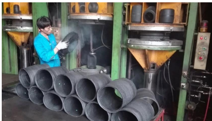
Obrázek 4 - Výroba pneumatik Vari ve vulkanizačních lisech (7)
