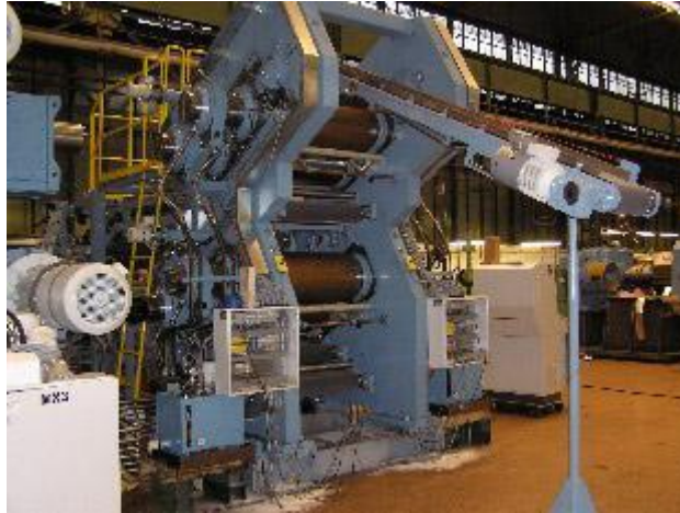
Obrázek 13 - Kalandr 03891 s průměrem válců 462 mm a jejich délkou 1020 mm (9)
