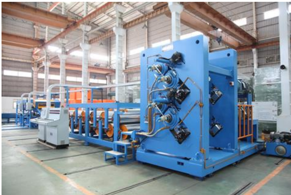
Obrázek 21 - Kalandr typu X, neboli inner-roller, firmy HYMC (12)
