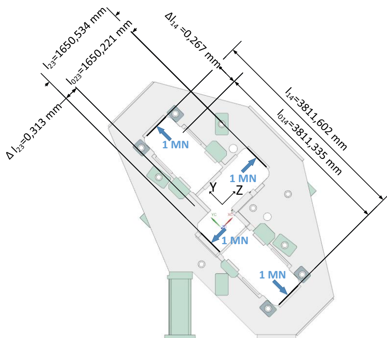
Obrázek 62 - Odečítání deformací v modelu kalandru
