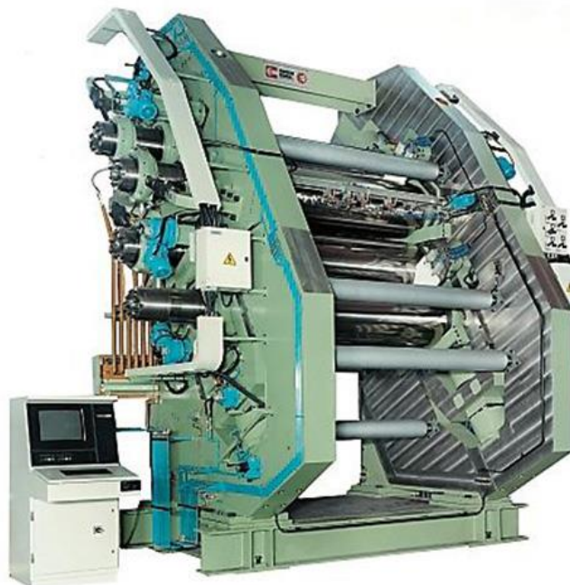
Obrázek 14 - Kalandr CG4 660x2200 - S firmy Comerio Ercole s nákresem linky pro výrobu dopravníkových pásů (8)
