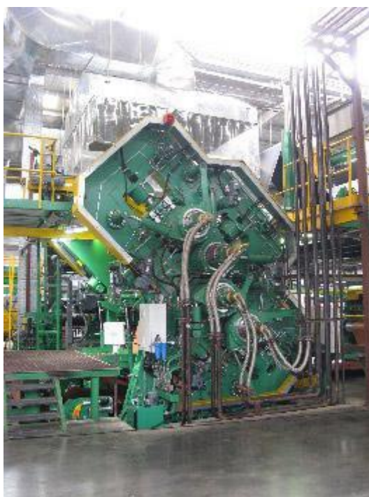
Obrázek 12 - Kalandr 03741 s průměrem válců 650 mm a jejich délkou 1800 mm (9)
