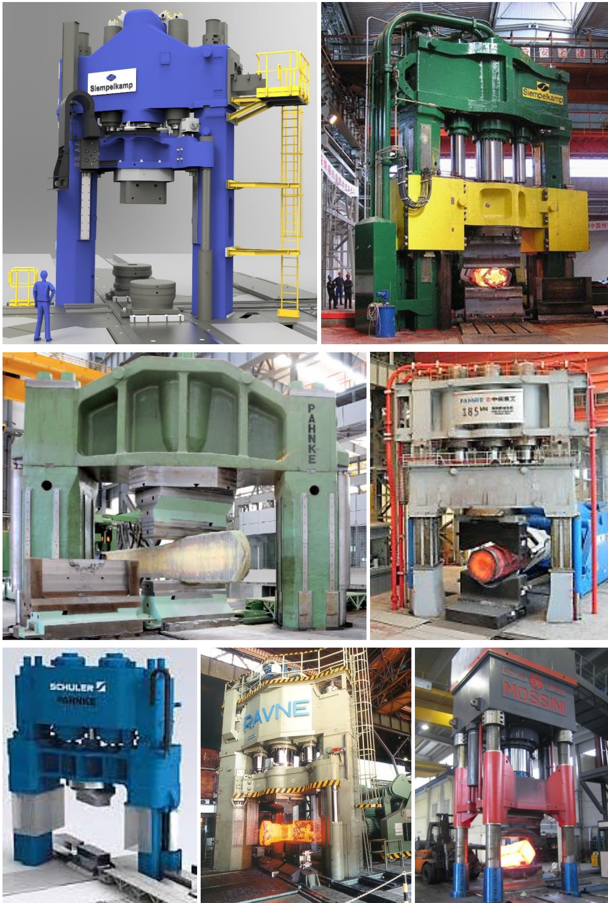
Obr. 6-2: Hydraulické kovací lisy pro volné kování [10], [11], [12], [13], [14]
