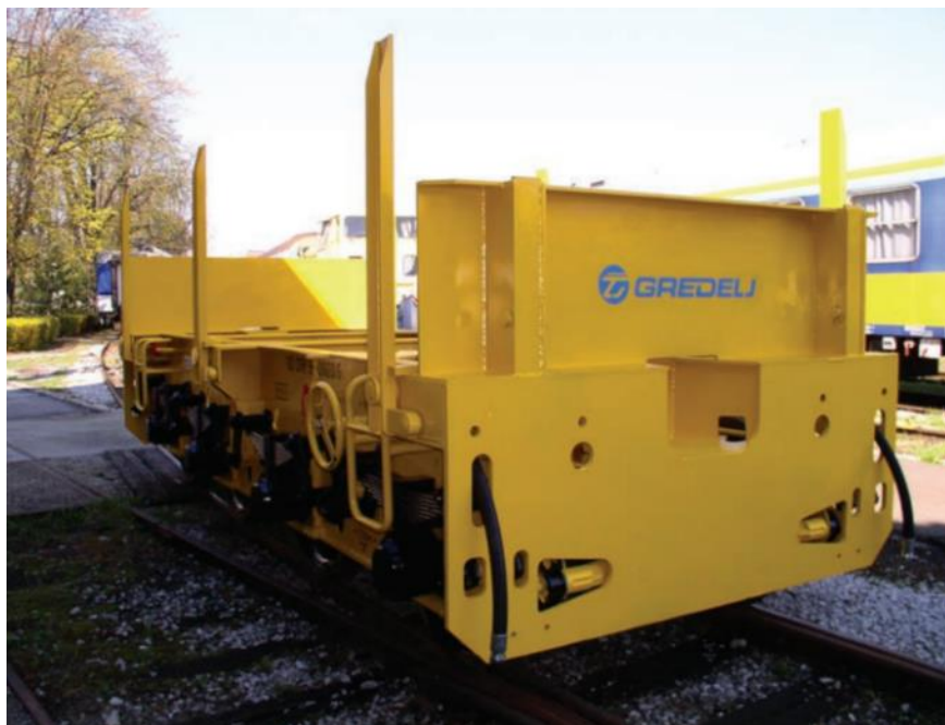
Obr. 31 Čtyřnápravový podvozek firmy Gredejl [14.14]
