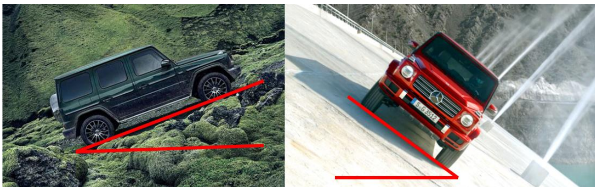
Obr. 7 Podélný a příčný náklon vozidla [11] [12]
