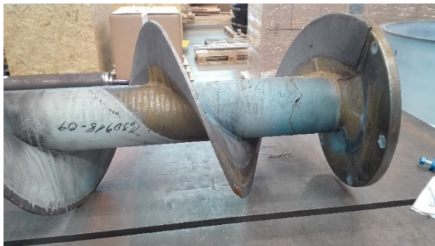
Obrázek 21 - Ukázka praskliny na šneku
