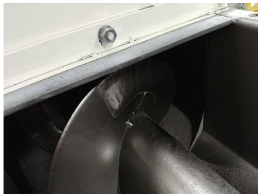
Obrázek 24 - Nadměrné opotřebovaný šnek
