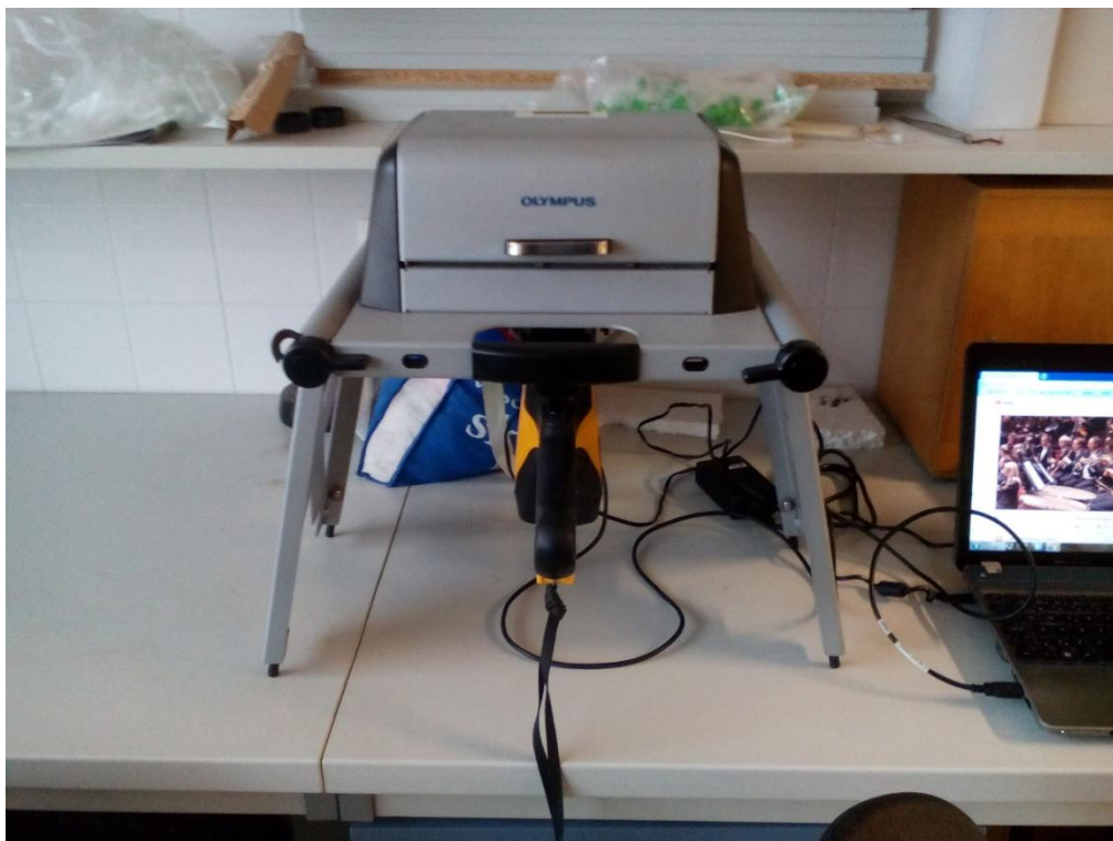
Obr. 14 – Přenosná měřicí komora s připojeným ručním XRF spektrometrem použitá k měření zpracovaných vzorků (foto: Pavel Behenský, 1. 2. 2019)
