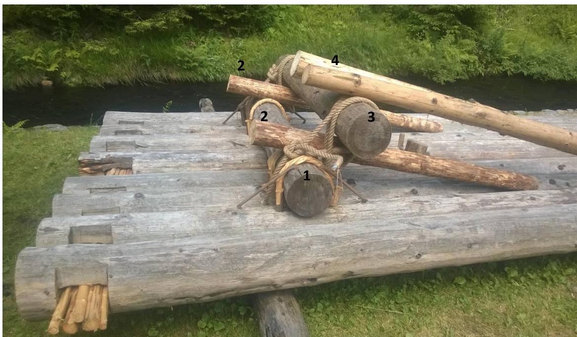
Obr. 22: Detail zadní části posledního voru – šreku, kde 1 – podjezd', 2 – pančavy, 3 – válec, 4 – pamvalík Foto: Natálie Odrášková, 7.7.2018
