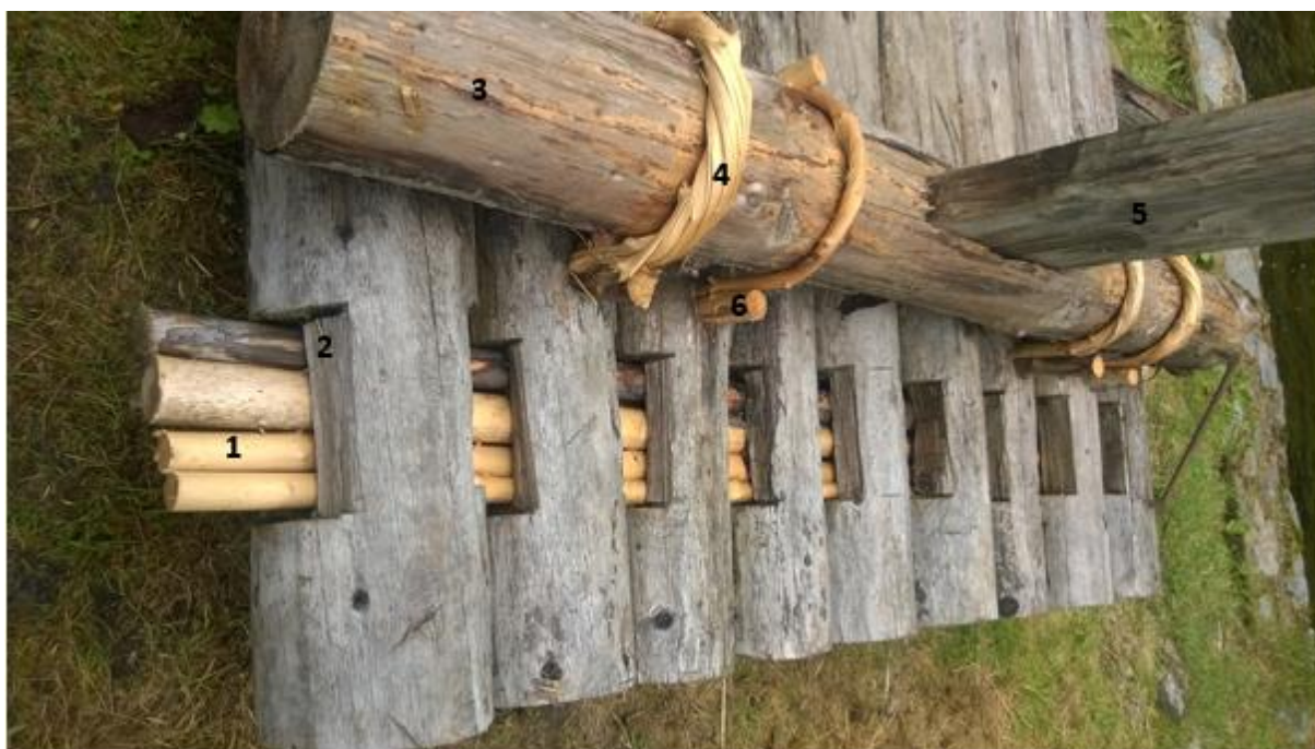
Obr. 23: Detail přední části předáku, kde: 1 – vořina, 2 – ušení, 3 – svlak, 4 – houžve, 5 – nožice, 6 – sluk Foto: Natálie Odrášková, 7.7.2018
