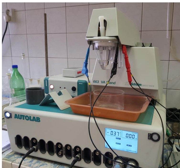
Obrázek 5 Sestava polarografu: potenciostat, kapková elektroda a rozhraní
