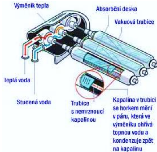
Obr. 4.2 Schéma trubicového solárního kolektoru heat-pipe [20]
