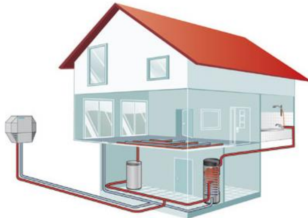
Obr. 4.9 Grafické znázornění tepelného čerpadla vzduch/voda [25]
