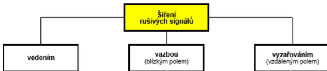
Obr. 4.1 Způsoby šíření rušivých elektromagnetických signálů (1)
