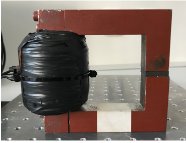
Obr. 9: Magnetický obvod použitý k měření permeability.
