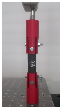
Obr. 16: Přípravek použitý k měření vzorků v tahu.
