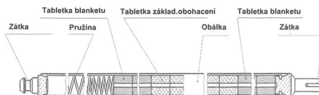
Obr. 5.13 – Konstrukce palivového proutku [20]
