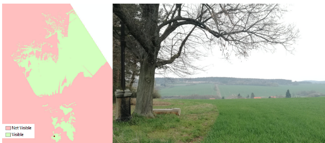
Obr. 4.20 Výstup viditelnostní analýzy (z červeného bodu v dolní části levého obrázku) nad modelem DMP 1G (ČÚZK, 2013) v porovnání s reálným výhledem na snímku napravo.
