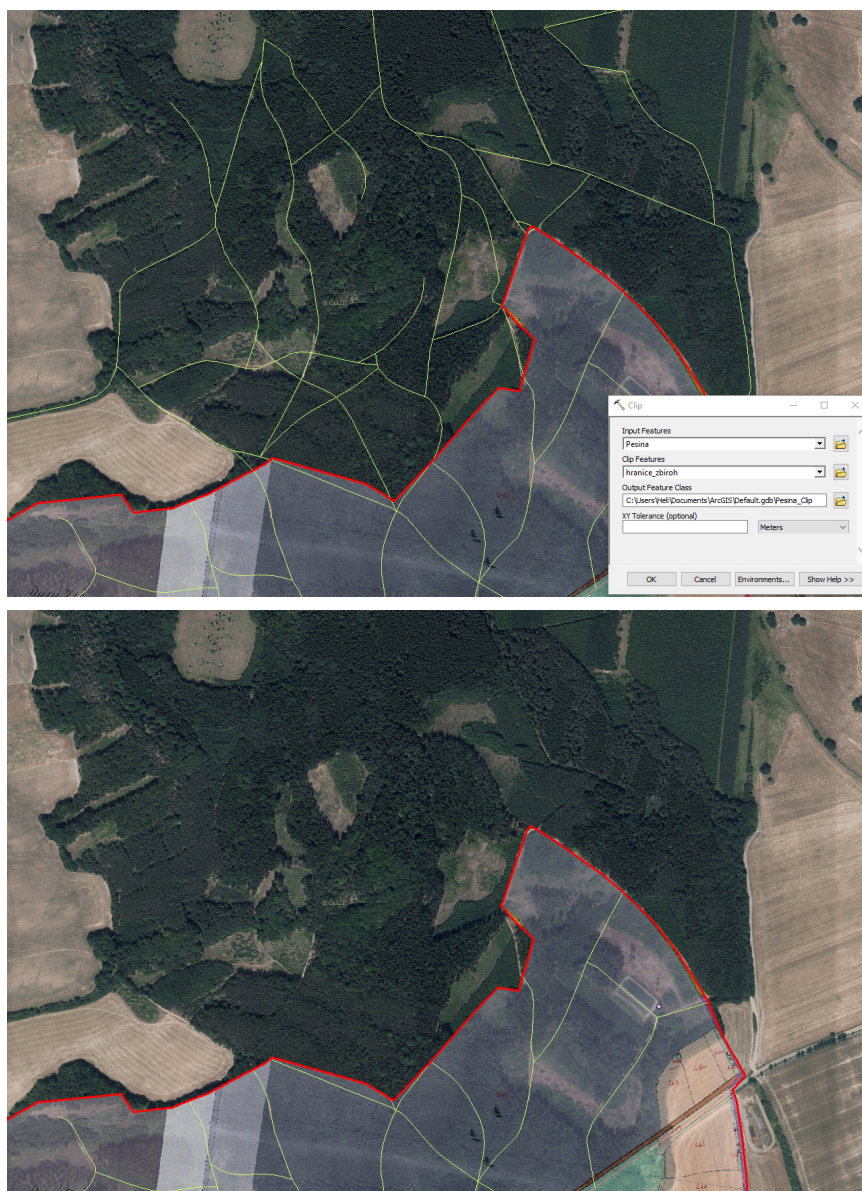
Obr. 4.1 Ořez dat ZABAGED® (ZABAGED® - polohopis, 2019) podle zájmového území na překrytí map aktuálního ortofoto snímku (Geoportál ČÚZK, 2010) a Stablního katastru z let 1826-1843 (ČÚZK, 2010). Podkladová data © ČÚZK.
