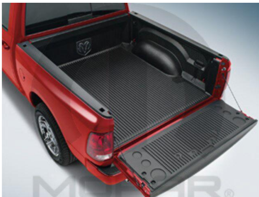
Obrázek 11 Korba pickupu - ukázka využití topografické optimalizace [10]
