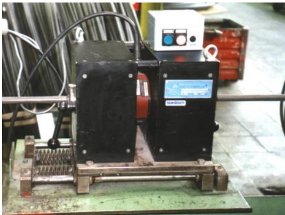
Obrázek 26 Detekce vady v trubce pomocí vířivých proudů [5.0.1]
