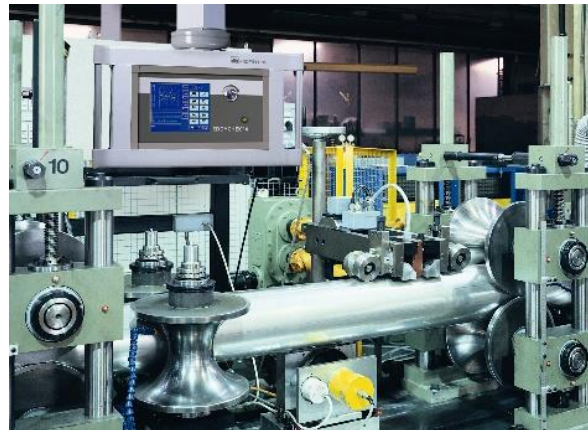
Obrázek 25 Kontrolní stolice pro průběžnou kontrolu svaru trubky [5.0.2]
