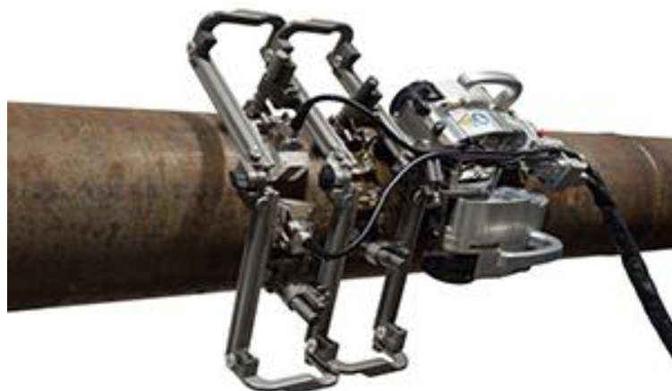
Obrázek 27 Robot SteerROVER firmy Olympus s nástabou pro kontrolu trubek[5.0.3]
