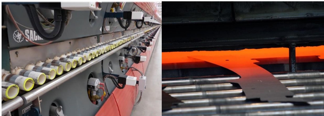
Obrázek 4 Válečkový dopravník v kontinuální peci (1)
