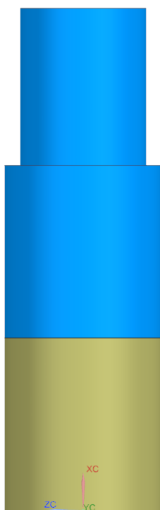
Obrázek 20 Základní provedení skládaného sloupu
