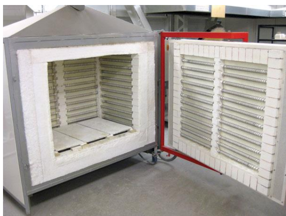
Obrázek 5 Topná tělesa pece (1)
