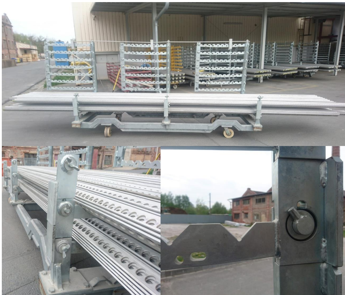
Obrázek 53 Třísloupový vůz pro extrémně dlouhé válečky
