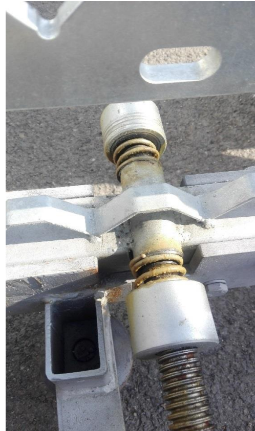
Obrázek 50 Detail pružin tlumících rázy
