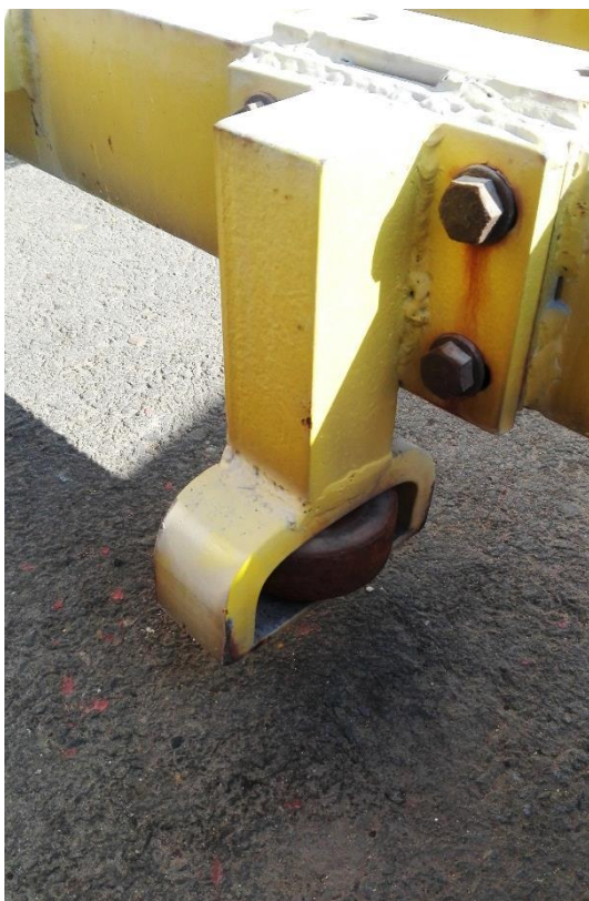
Obrázek 12 Kladka umístěná na čelníku vozu
