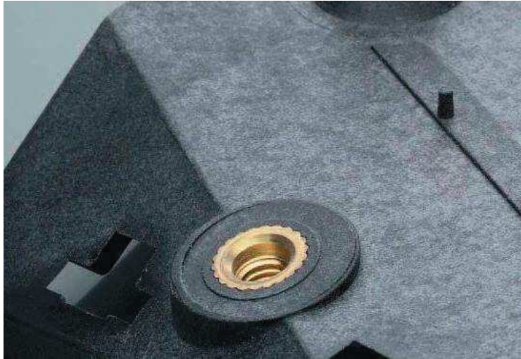
Obr. 60: Příklad závitové vložky zalisované do plastu [33]
