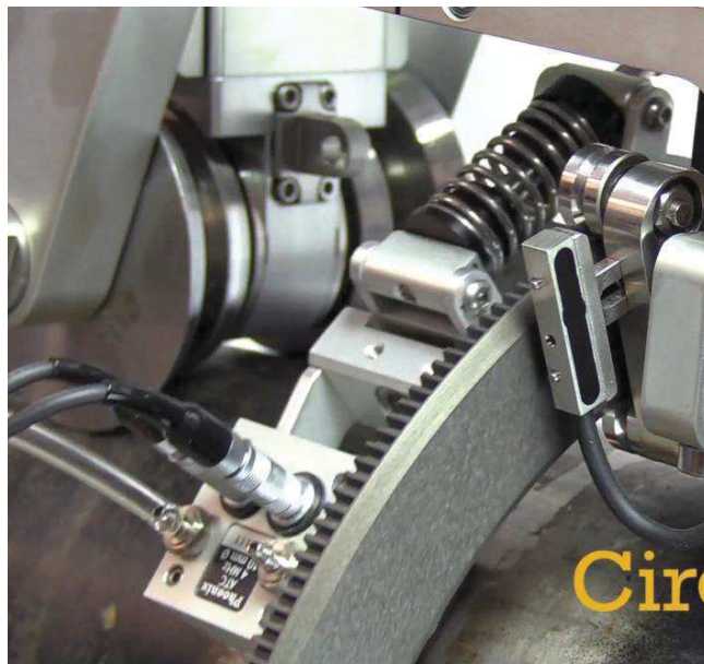
Obr. 34: Přítlak sondy pomocí vinuté pružiny - PET Scanner [12]
