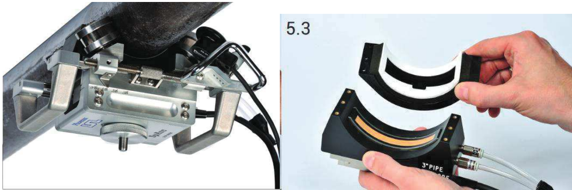
Obr. 44: Těsnění mezi sondou a trubkou v systému Sp-Arc [24]
