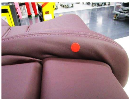
Obrázek č. 24. Neshody nalezené zákazníkem - zvlnění potahu
