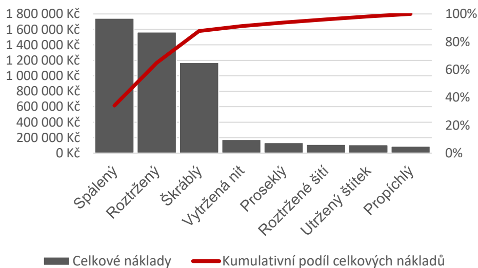
Graf č. 8. Paretův diagram - příčiny poškození potahu
