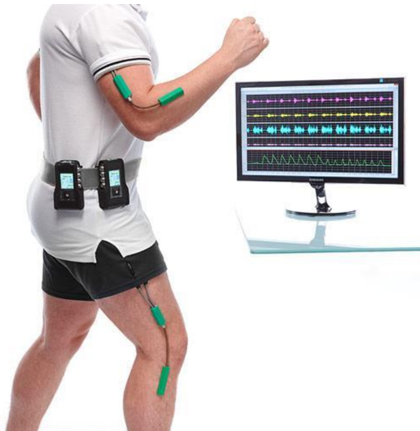
Obr. 2-4 Měření pomocí goniometrů [24]
