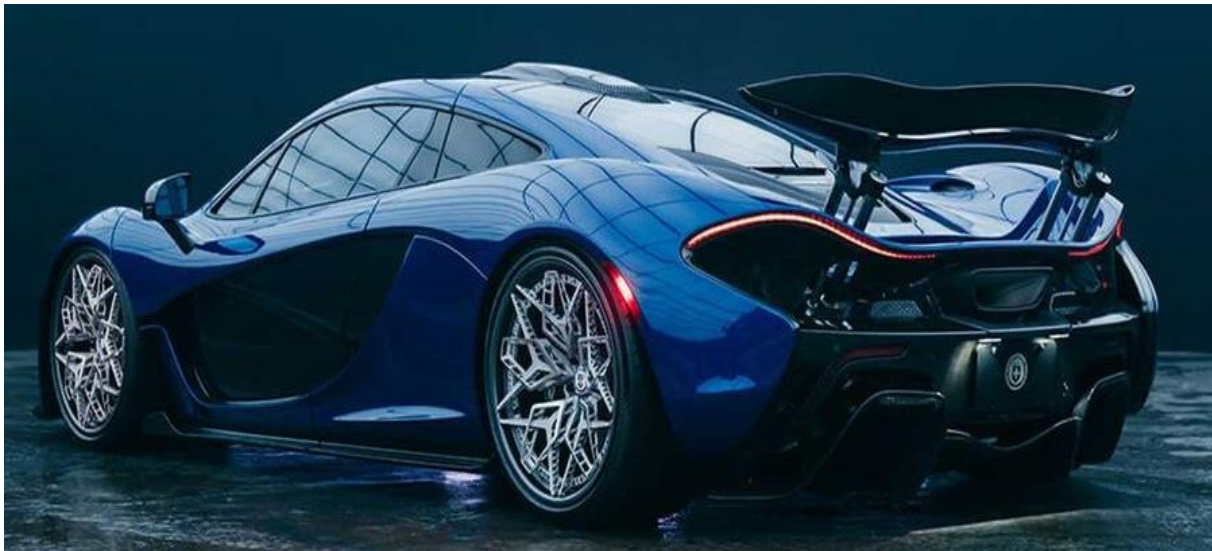
Obrázek 1-6 První automobilové kolo z titanu vyrobené aditivní výrobou [14]
