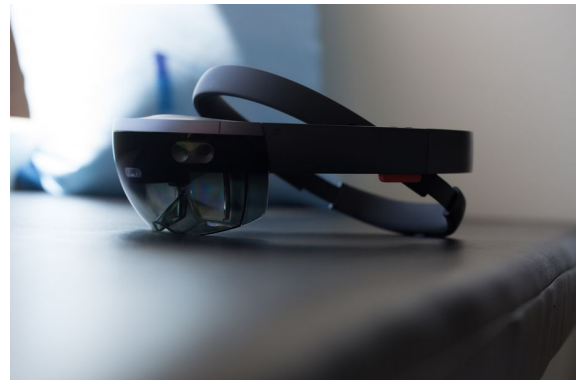
Obrázek 9 – Ukázka HMD s průhledným displejem Microsoft Hololens [2]
