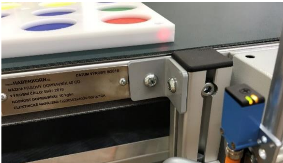
Obrázek 5-3: Instalované optické čidlo
