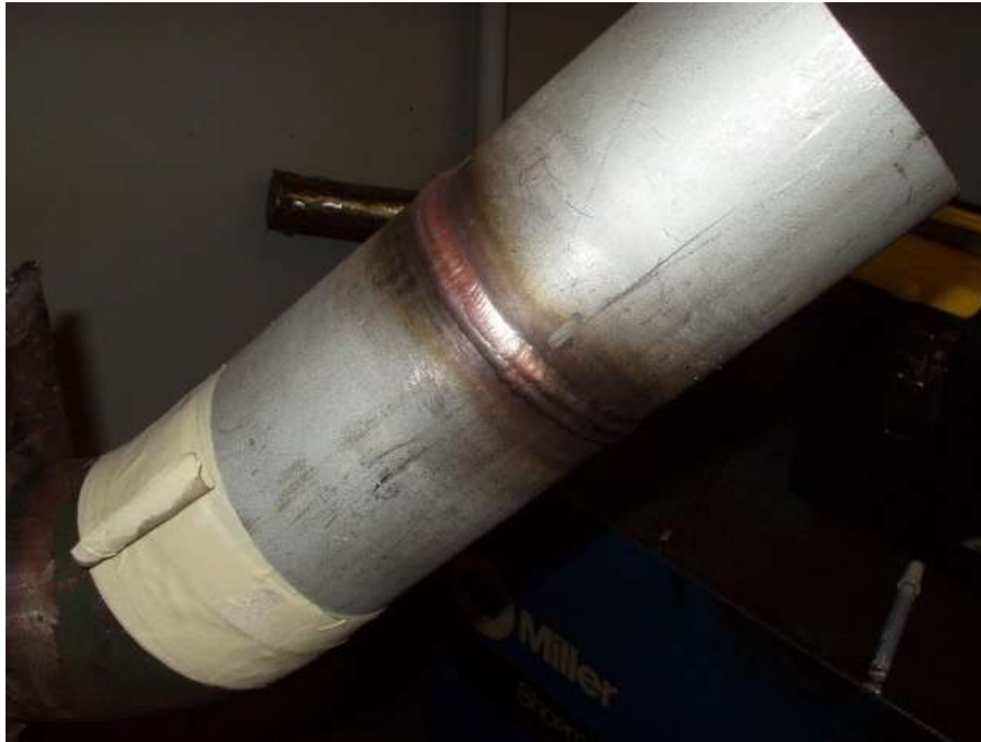
Obrázek 9. Svařovaný spoj potrubí [20]
