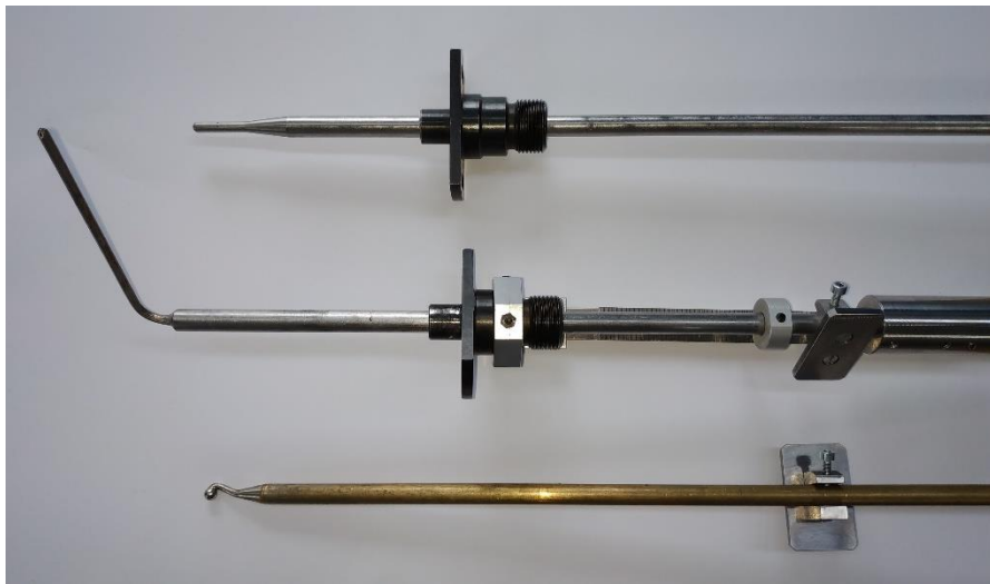
Obr. 10-2: Pneumatické sondy - tříotvorová sonda; pěti-otvorová kuželová L sonda; pětiotvorová kulová sonda
