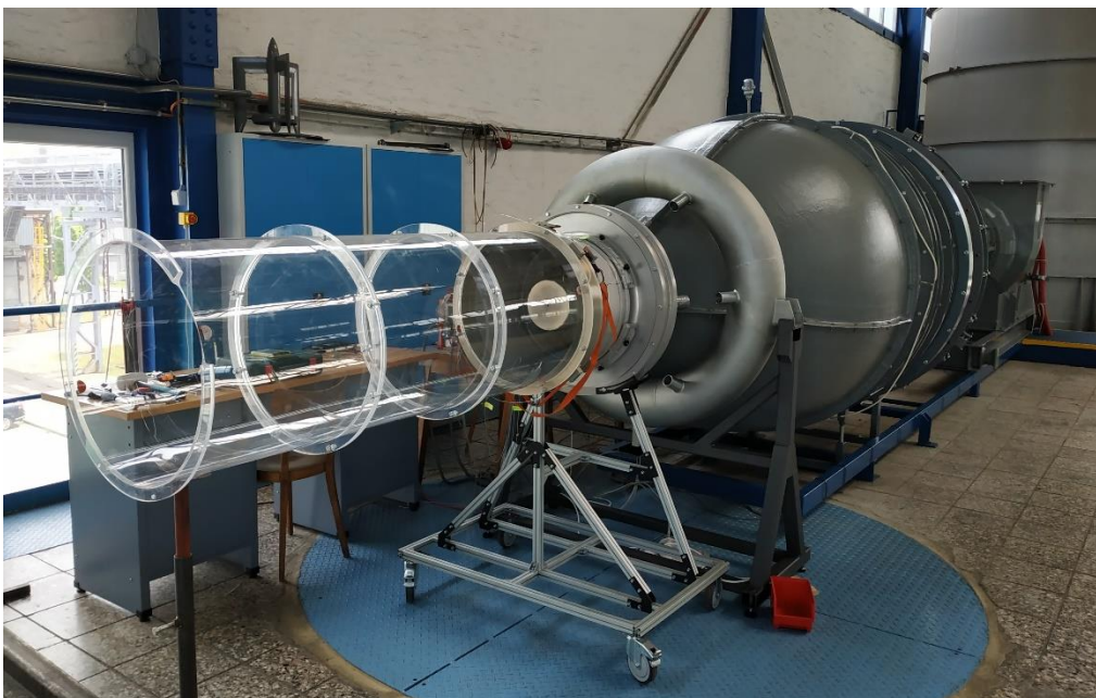
Obr. 5-1: Model výstupního tělesa s prodlužovacím potrubím
