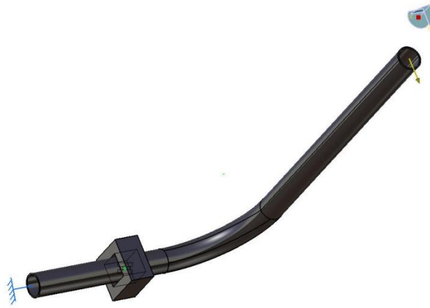
Obrázek 6 – OHYB 4D – zatížení na krut
