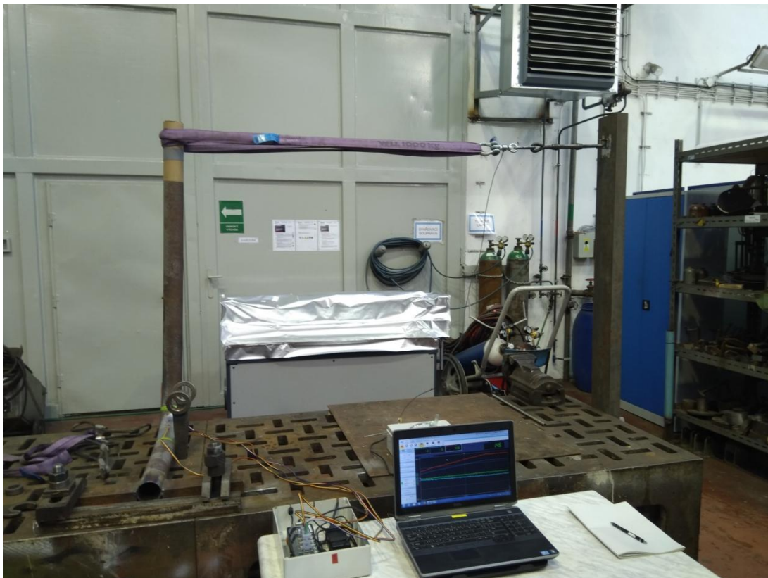
Obrázek 51 – Průběh experimentu – sestava kompletního zapojení (zatěžování na krut)
