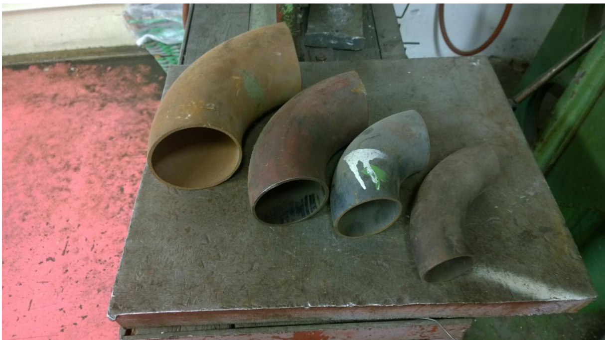
Obrázek 37 – Kolena s vnějším průměrem 58 mm, 76 mm, 87 mm, 106 mm
