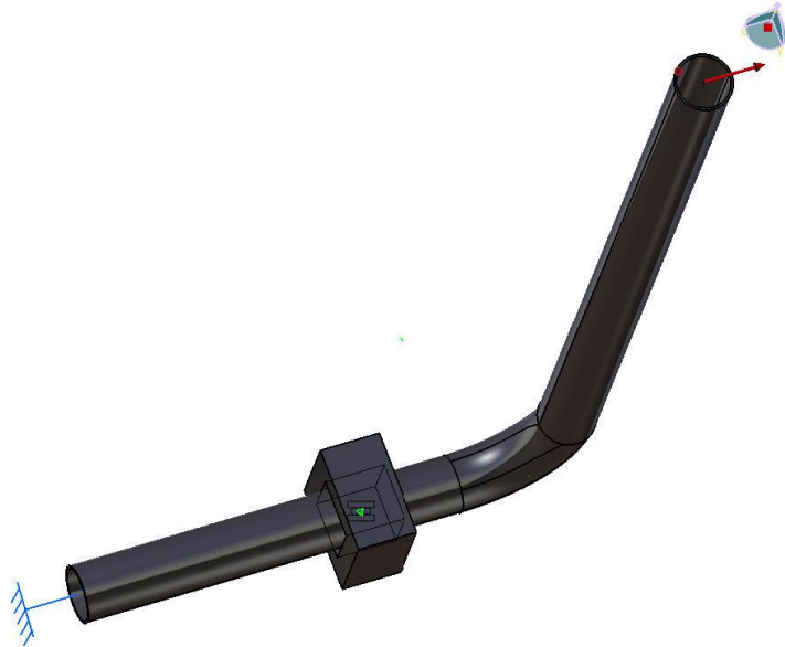
Obrázek 12 – KOLENO 1,5D – zatížení na ohyb
