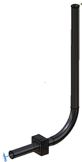
Obrázek 5 – OHYB 4D – zatížení na ohyb
