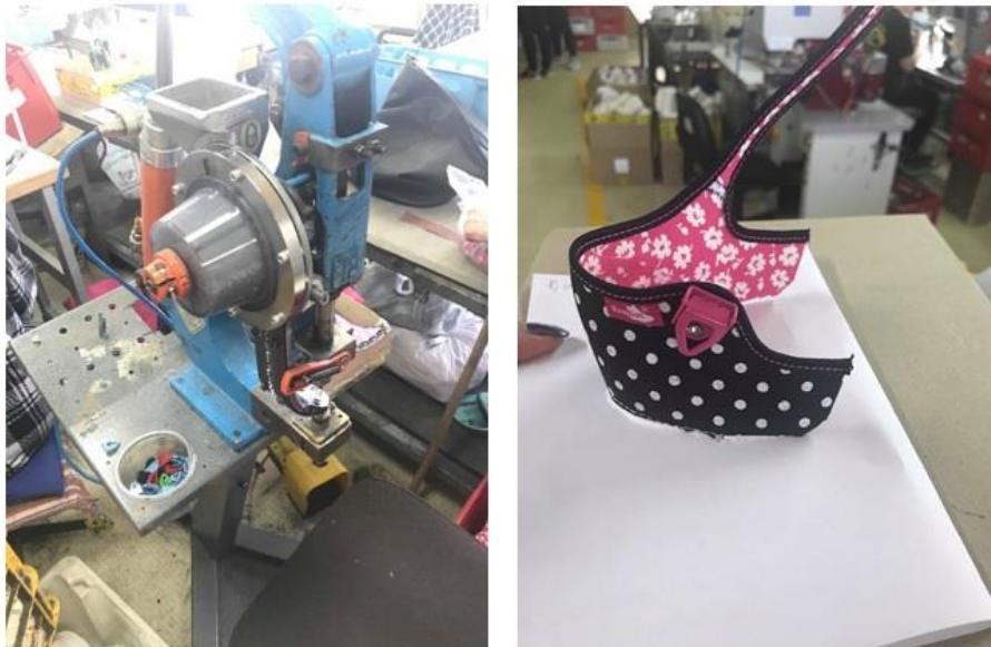
Obrázek 22: Upevnění nýtku pomocí stroje
