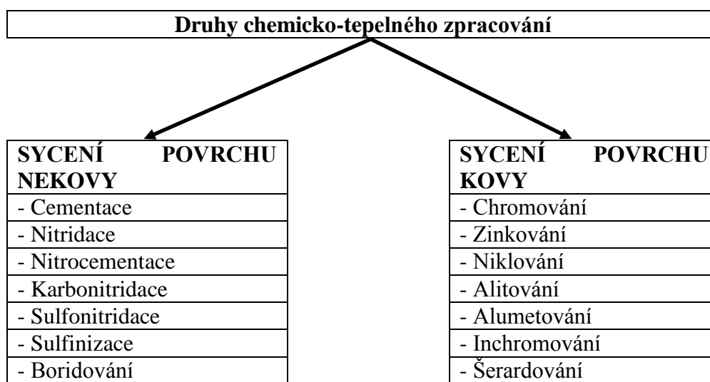
Obrázek 3-1: Druhy chemicko-tepelného zpracování [10]
