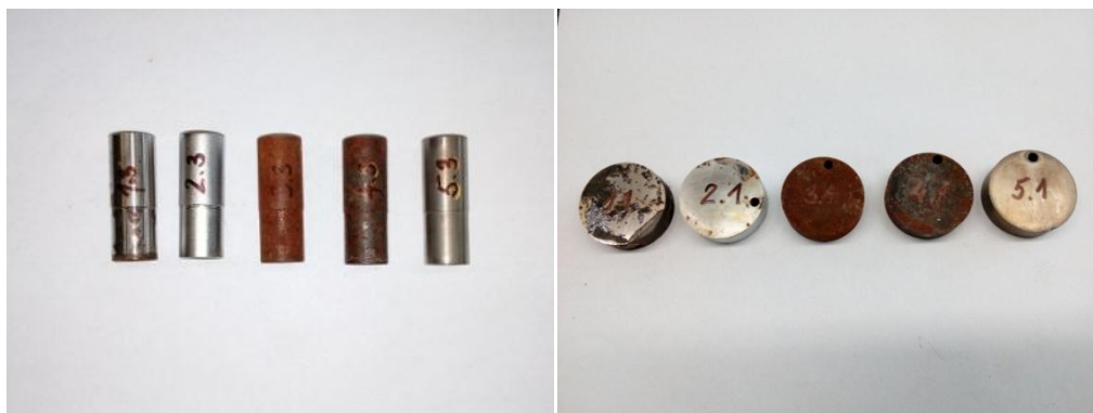
Obrázek 9-2: Korozie povrchu vzorků oceli 32CrMoV12-10 (vlevo) a 31CrMoV9 (vpravo), (řazeno zleva - originální vzorek, chromová vrstva, boridová vrstva bez TZ, boridová vrstva s TZ, nitridová vrstva)
