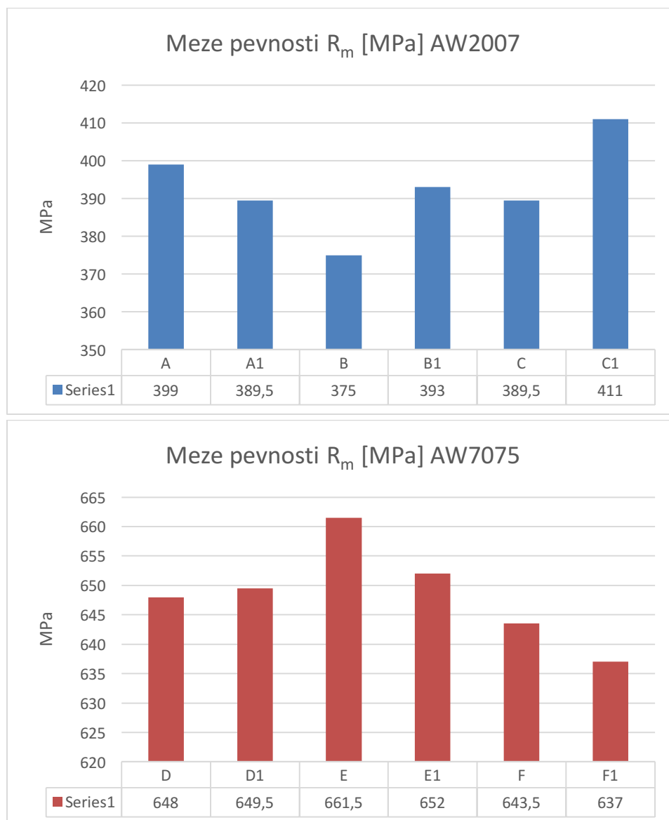
Obr. 93 Grafy hodnot meze pevnosti R_m [MPa] AW2007 a AW7075
