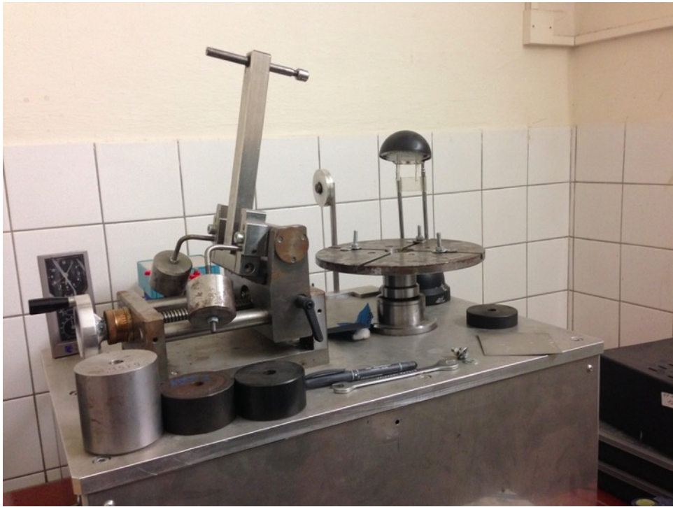
Obr. 27 Zařízení pro tribologické testování na KMM ZČU
