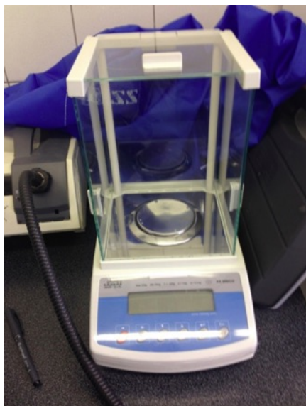
Obr. 28 Váha, jež byla využita k měření váhy a váhových úbytků u jednotlivých vzorků
