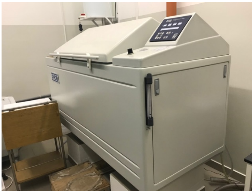
Obr. 76 Korozní komora Q-FOG – CCT 600 na KMM ZČU
