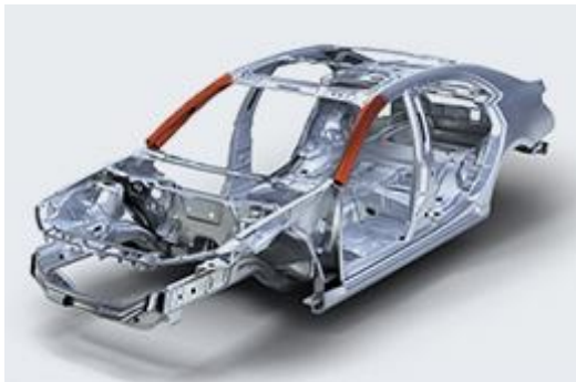
Obr. 10. – Použití TRIP oceli a umístění v karoserii [11]
