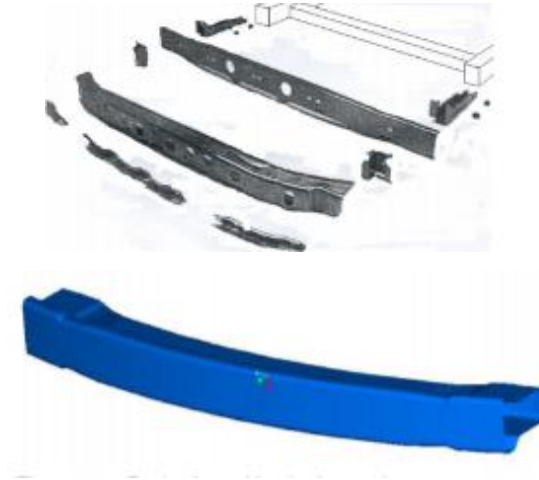
Obr. 19. Příklady typicky vyráběných součástí pomocí hydroformingu trubek [24]
