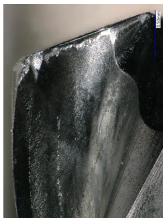
Obrázek 4-5 Opotřebení na čele u vrtáku bez házení a s házením 0,15 mm – pohled z 2 stran [autor]
