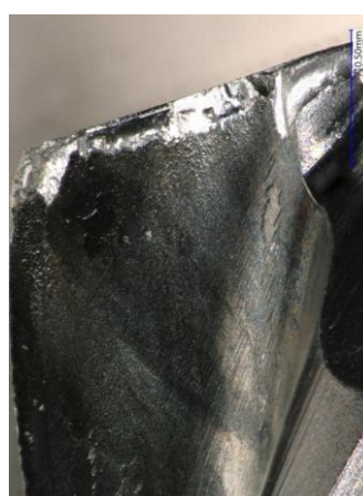
Obrázek 4-5 Opotřebení na čele u vrtáku bez házení a s házením 0,15 mm – pohled z 2 stran [autor]
