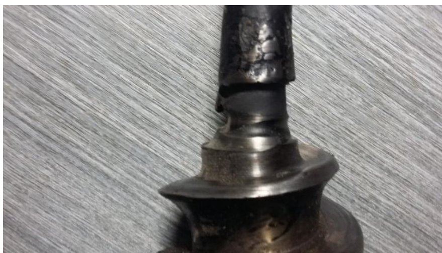
Obrázek 14: Opotřebení nástroje – drážka + závit [22]
