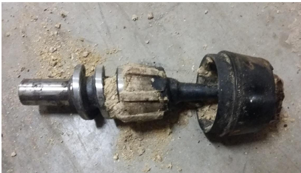
Obrázek 9: Částečně slisovaný materiál[17]
