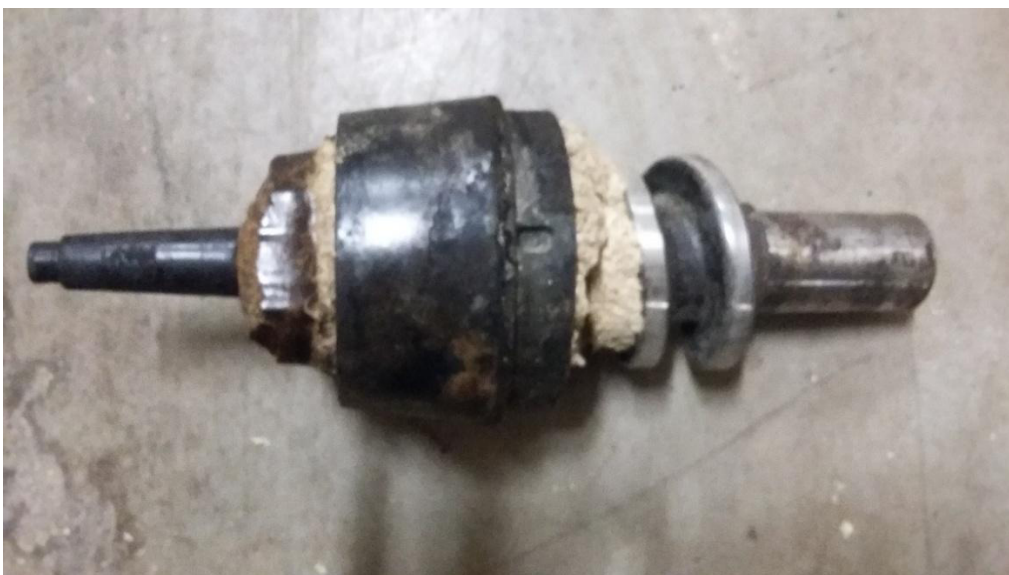
Obrázek 8: Briketa tvořící se v primární matrici [16]
