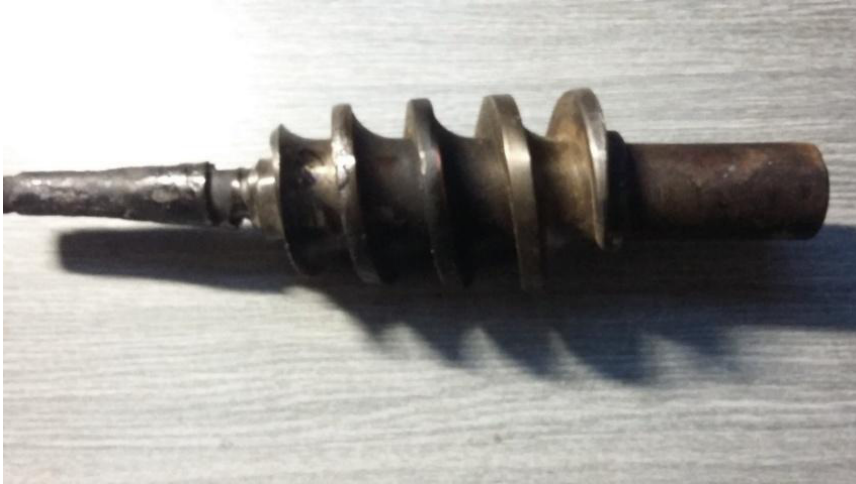
Obrázek 15: Opotřebení nástroje - drážka [23]
