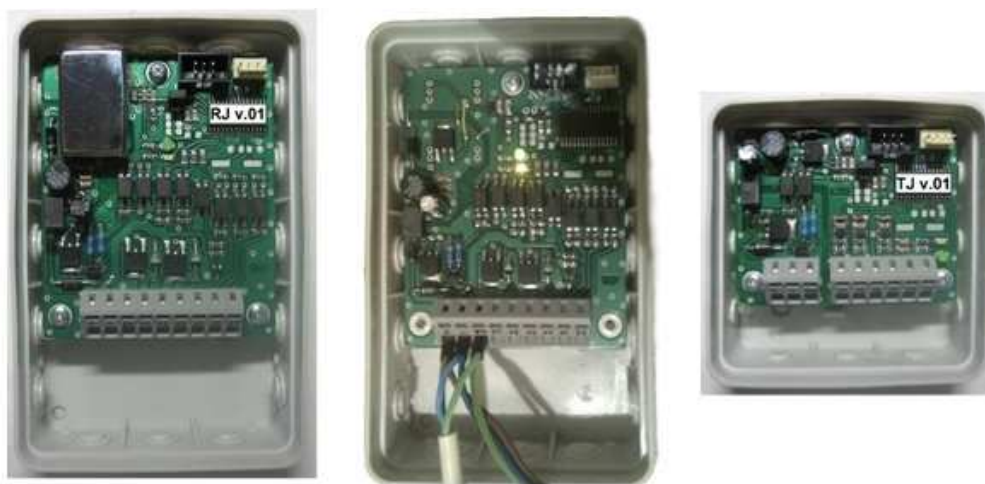
Obrázek 31: Zleva: Řídicí jednotka RJ s DC/DC měničem, řídicí jednotka RJ s lineárním měničem 7805, teplotní jednotka TJ
