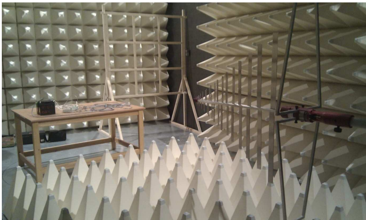
Obrázek 33: Zkouška odolnosti protii vř elektromagnetickému poli v bezodrazové komoře ZČU FEL
