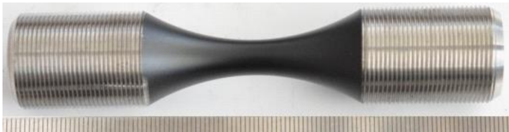
Obr. 3-53 Úprava povrchu tělesa s proměnným průřezem s využitím vysoko emisivní barvy
