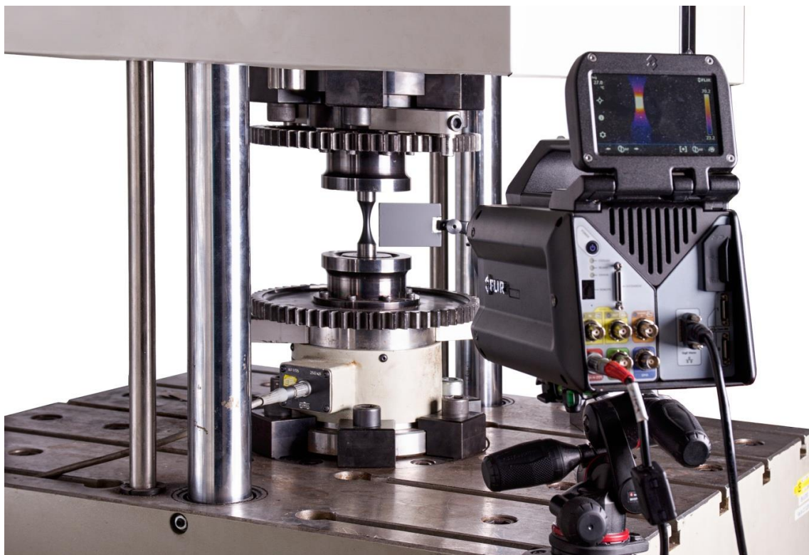
Obr. 3-55 Zkušební sestava VCÚ s využitím termografie
