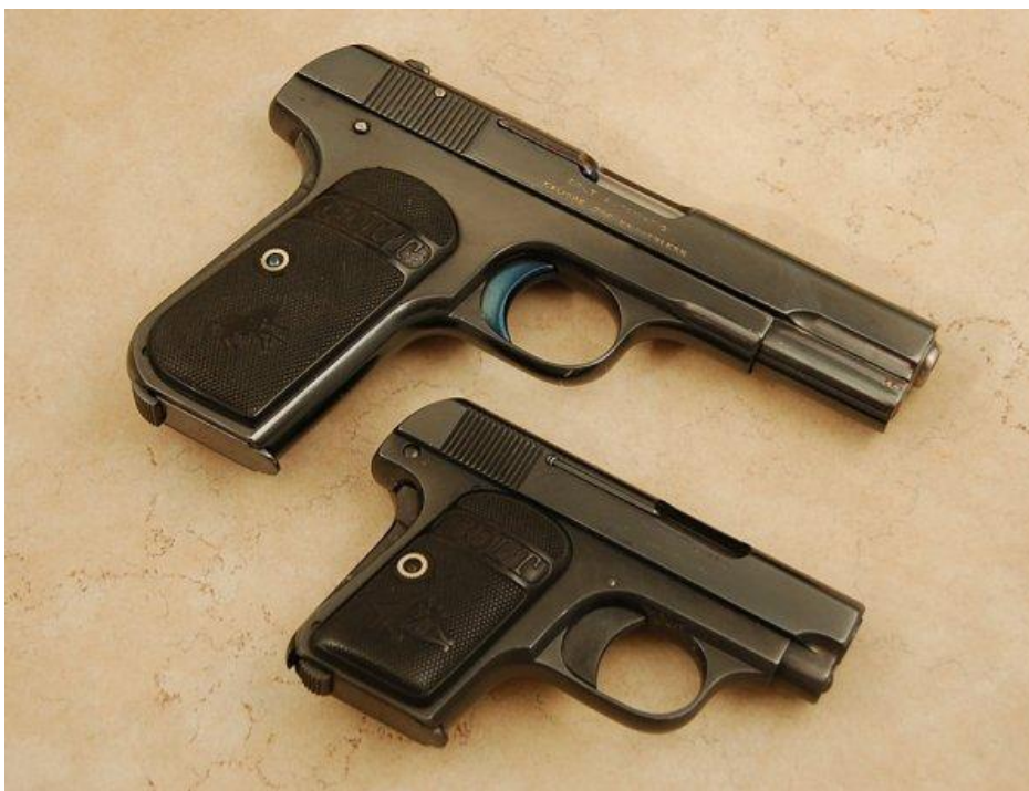
Obrázek č. 10. Srovnání obou modelů ve službách Zvláštní skupiny D. Nahoře Model 1903 a pod ním Coltova verze Browningova Modelu 1906. Menší z modelů prakticky umožnil pouze sebeobranu na nejkratší vzdálenost, neboť nebyl vybaven mířidly.
