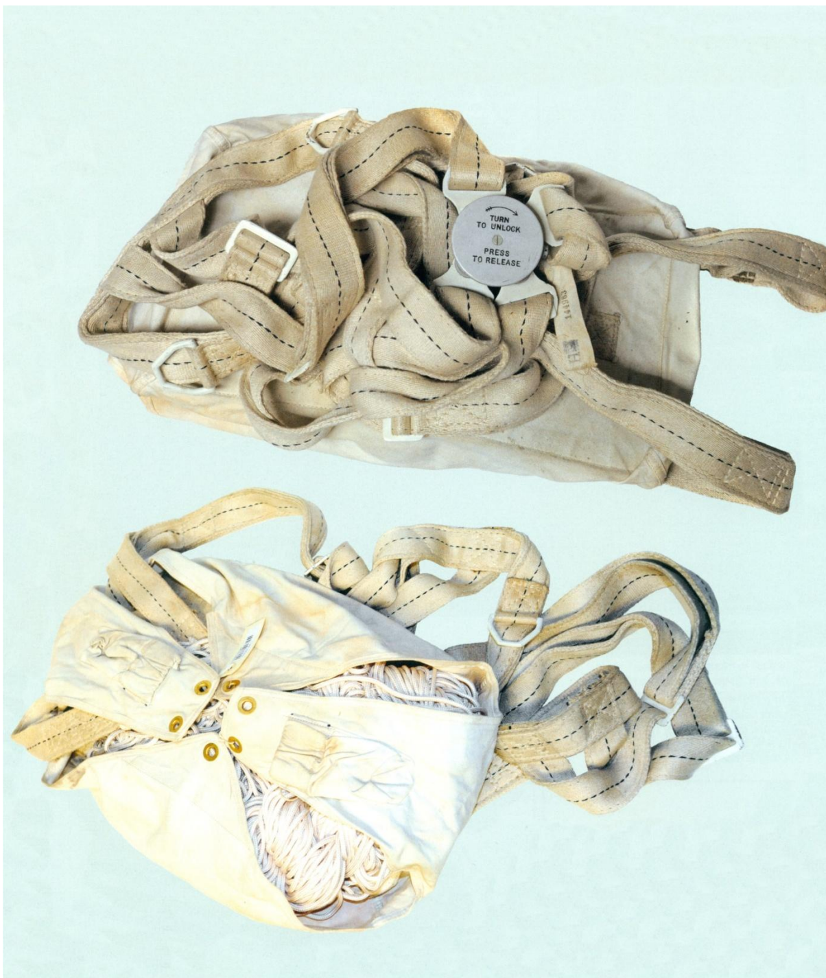
Obrázek č. 45. Padák X Type, určený primárně pro zasazení padákových agentů v severských zemích.
