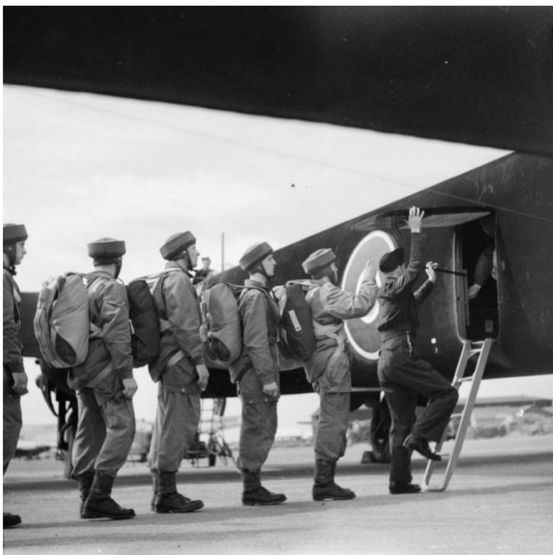
Obrázek č. 21. Nástup parašutistů do letounu. Barvy kontejnerů padáků i nosného postroje nebyly jednotné a bylo mnoho variant. Podle vnějších kapes pro výtažné lano, umístěných na chlopních kontejneru padáku, je zřejmé, že parašutisté jsou vyzbrojeni modelem X Type Mk. I.
