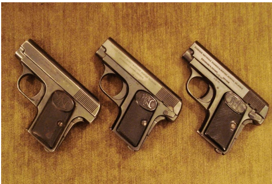
Obrázek č. 11. „Menší bratr“ FN Browning Model 1906 byl v podstatě miniaturou Modelu 1903. Zbrojovka Colt neprojevila o design zpočátku zájem a výroba se uskutečnila v belgické zbrojovce (FN) Herstal. Hmotnost byla pouhých 350 gramů, kapacita zásobníku 6 nábojů ráže .25 ACP/ 6.35 mm. Pro srovnání: hmotnost pistole M1911 je 1100 gramů, kapacita zásobníku 7 ran ráže .45 ACP/ 11.43 mm.
