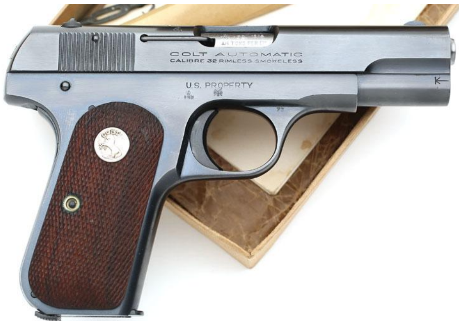
Obrázek č. 8. Pistole Colt Model 1903 Pocket Hammerless při pohledu zprava. Výroba modelu 1903 probíhala v letech 1903 až 1945. Hmotnost zbraně byla ve srovnání s M1911 téměř poloviční - 680 gramů, kapacita zásobníku byla 8 nábojů ráže .32 ACP/ 7.65 mm Browning.
