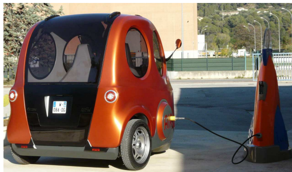
Obr. 6.4[6]: Plnění z kompresní stanice
