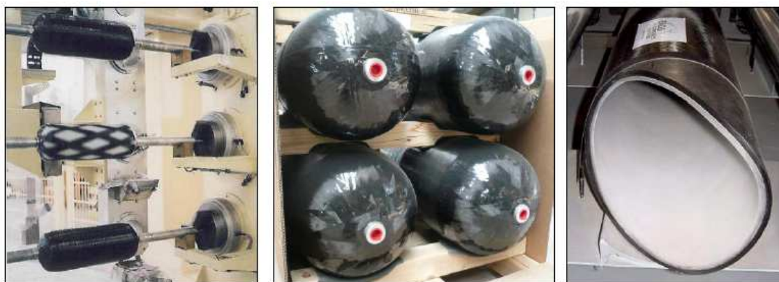
Obr. 6.1[6]: Nádrž na stlačený vzduch
