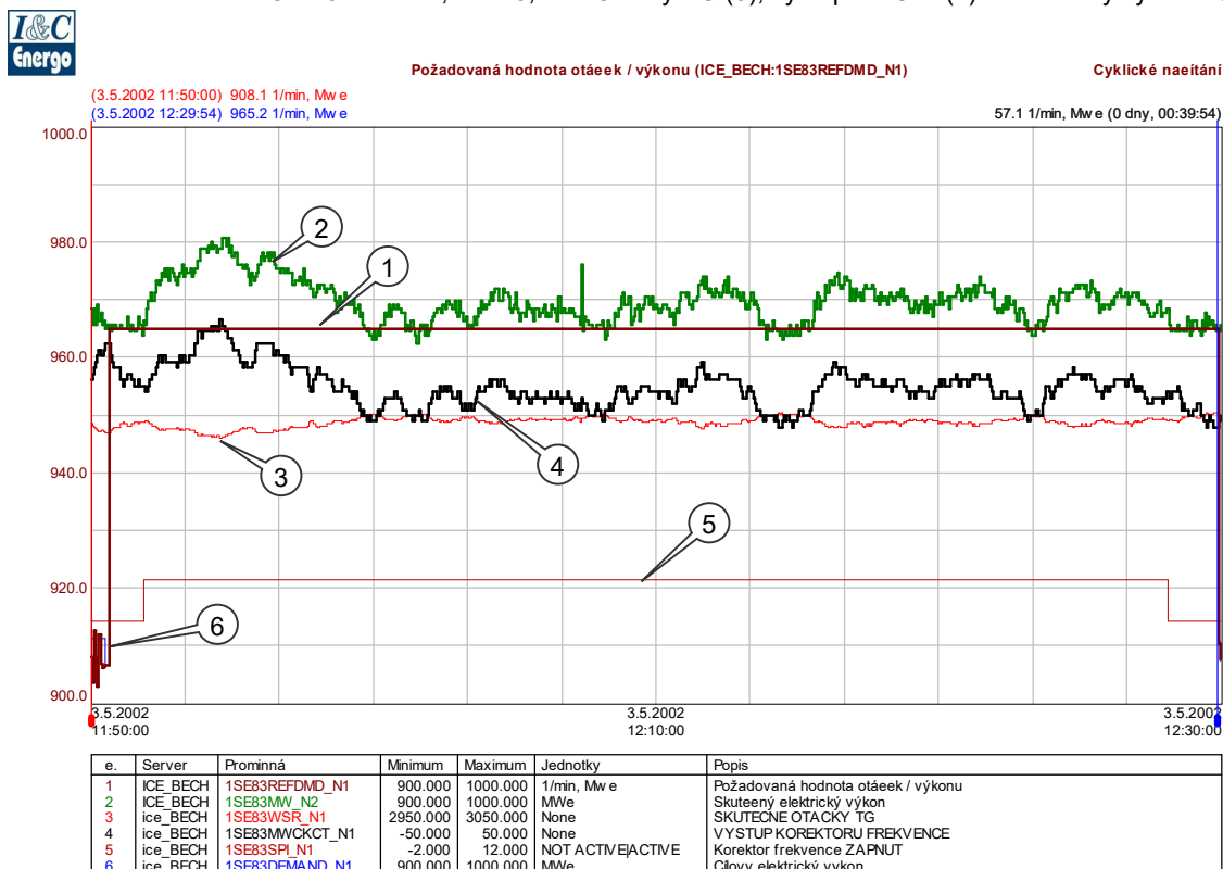
Obr. 32: ETE 1, Test 3, NP. Otáčky TG (3), výstup z KORf (4) a elektrický výkon TG (2),
