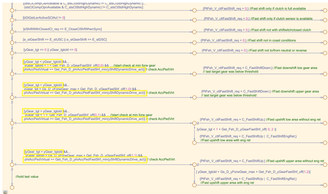
Obrázek 6.2: Ilustrační obrázek, kde je uveden příklad modelování if-else podmínek, ve kterých je každá jednotlivá podmínka složená z několika dalších. Je možné si povšimnout, že v každé složené podmínce figuruje jedna, která je pro všechny stejná.
