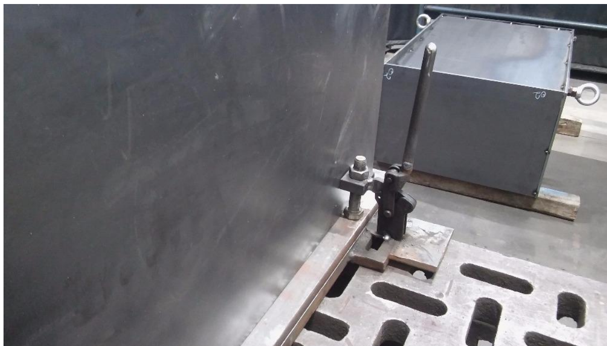
Obrázek 30: Umístění rychloupínačů vzhledem k celému tělu olejové vany
