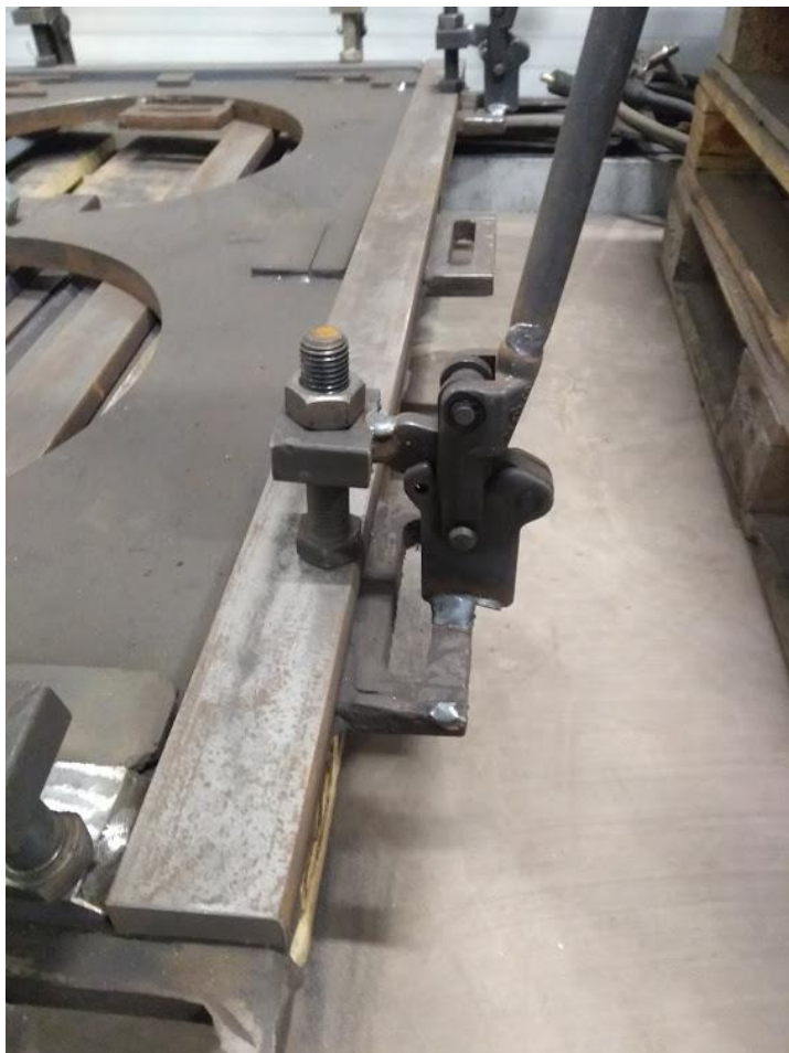
Obrázek 28: Uchycení pomocí rychloupínače
