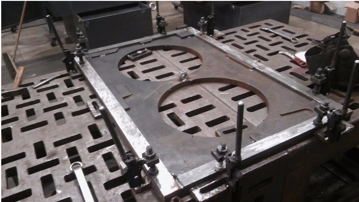
Obrázek 26: Svařovací přípravek pro přírubu malé vany
