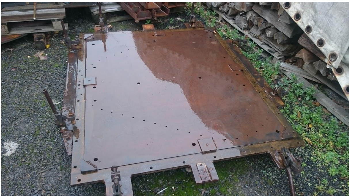
Obrázek 27: Svařovací přípravek pro přírubu velké vany
