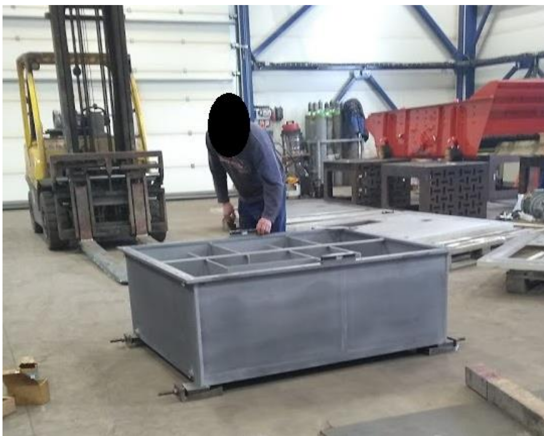
Obrázek 34: Uložení těla velké olejové vany na vyrovnávací patky
