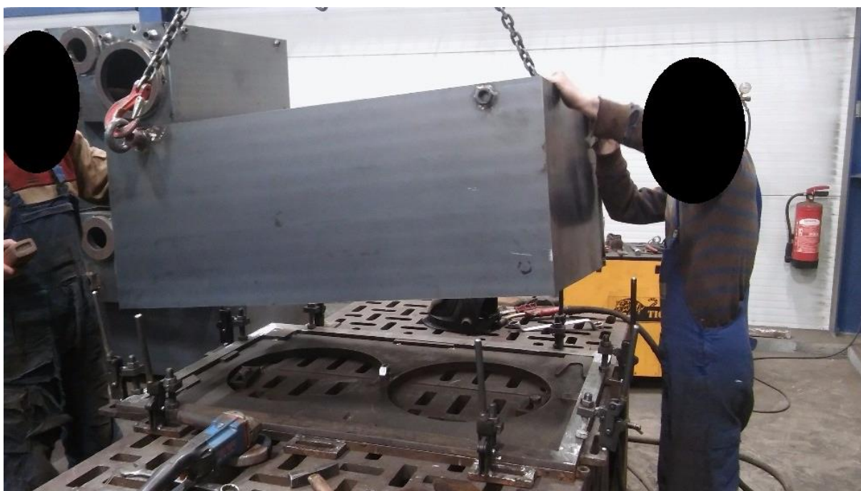
Obrázek 29: Usazování těla vany na přírubu v přípravku
