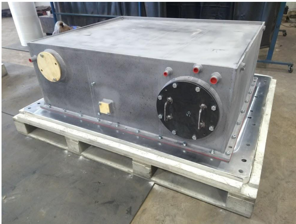
Obrázek 8: Pohled na čelo velké olejové vany
