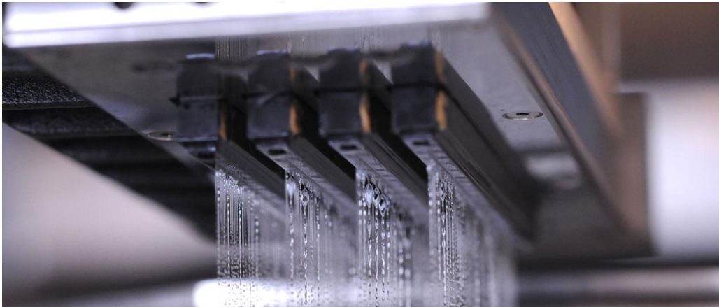
Obr. 1.10 Tryska tiskové hlavy pro Binder Jetting
