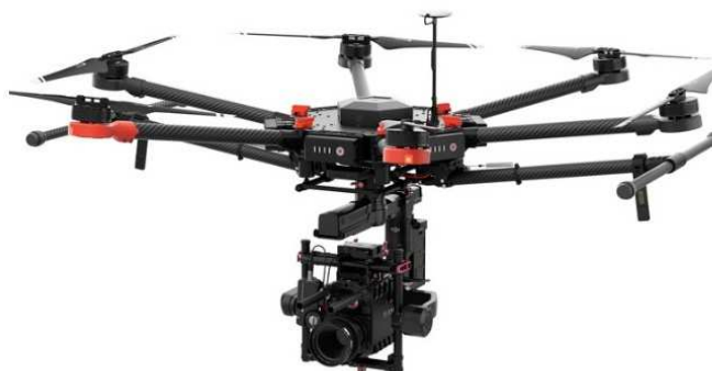
Obrázek 9 – DJI Matrice 600 Pro [19]
