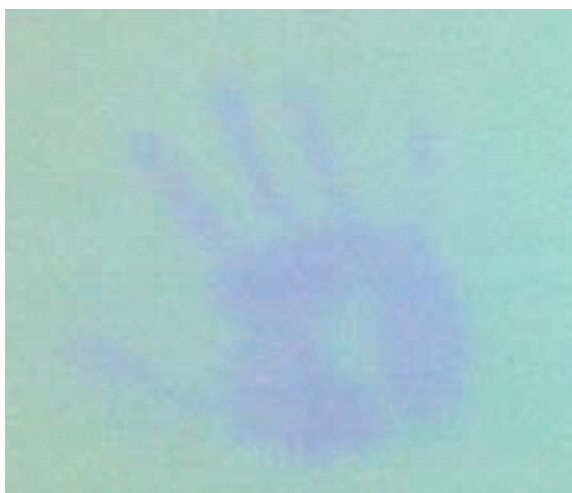
Obr. 3.4 Měření teploty termochromatickými přípravky [5]
