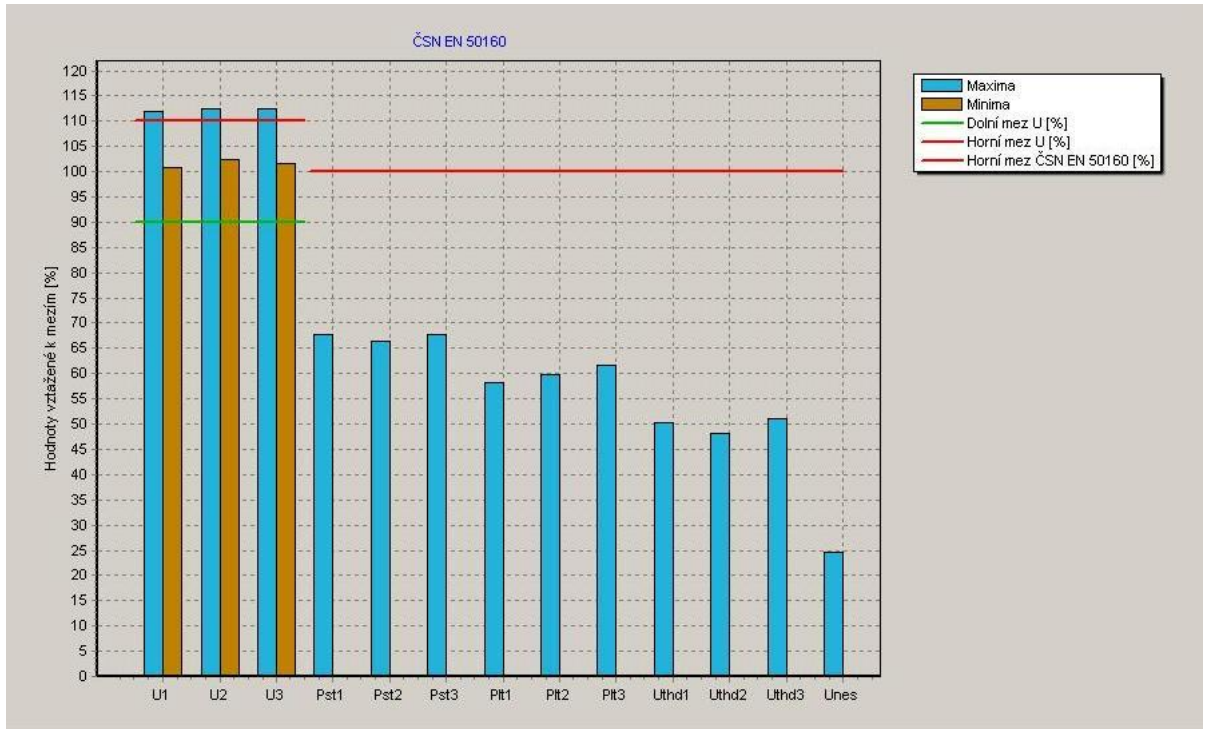
Obr. 10: Souhrnné výsledky provedeného měření v předávacím místě z pohledu kvality napětí (ČSN EN 50160)
