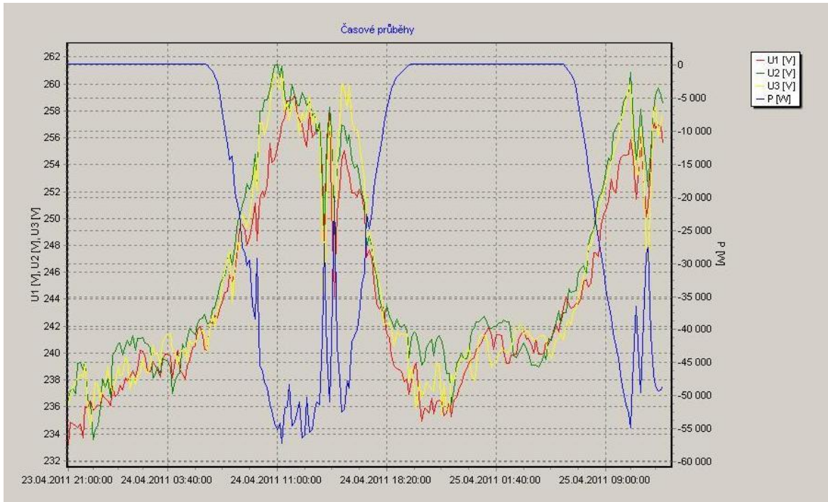
Obr. 8: Parametry napětí při maximálním provozu výroby v předávacím místě
