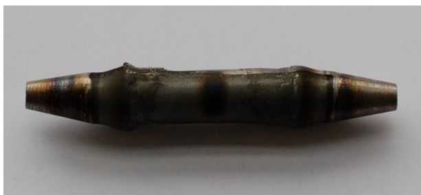
Obrázek 26: Vzorek oceli K390 po nevhodném režimu zpracování
