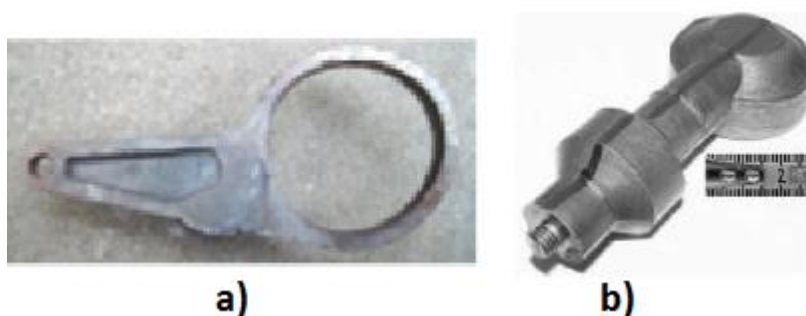
Obrázek 17: a) thixo lateral extrusion, b) thixojoining, produkty vytvořené tixoforingem z oceli X210Cr12 [4]
