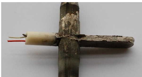
Obrázek 27: Příliš natavený vzorek oceli K390
