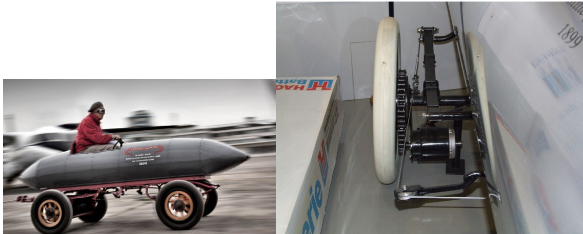
Obrázek 24 – Elektromobil Jamais Contente, obrázek zadní nápravy s převodem a elektromotorem [17]
