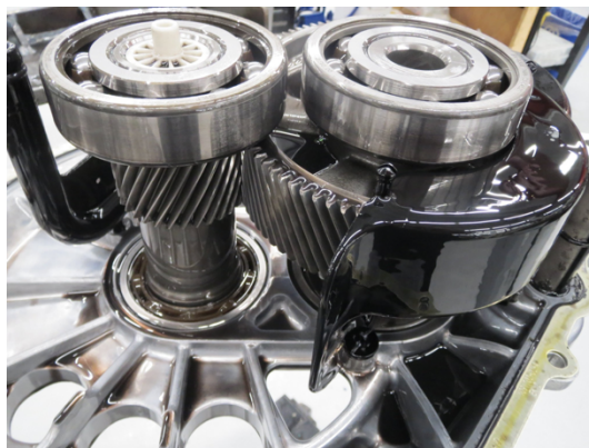
Obrázek 30 - Převodovka Tesla Model 3 po 1 milionu mil [54]
